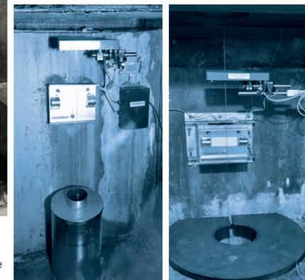
Además, suministramos sistemas automáticos Telelot VDD2v4, diseñados para medir las deformaciones horizontales de la presa. Estas mejoras marcan una mejora sustancial en las capacidades de monitoreo, garantizando la seguridad y eficiencia de la represa Sardar Sarovar en la India.
