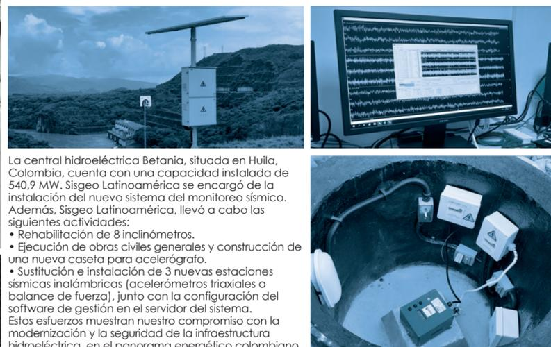
La central hidroeléctrica Betania, situada en Huila, Colombia, cuenta con una capacidad instalada de 540,9 MW. Sisgeo Latinoamérica se encargó de la instalación del nuevo sistema del monitoreo sísmico. Además, Sisgeo Latinoamérica, llevó a cabo las siguientes actividades:
