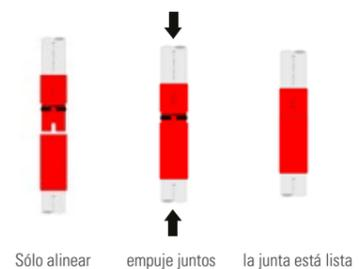
(1) Durante la fabricación particular atención se pone para minimizar la torsión de las tuberías inclinométricas en modo de mecanizar la ranura para la unión de las tuberías con manguitos de autoalineación.
