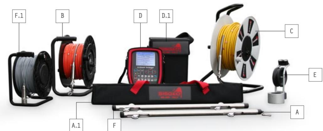
A Sonda inclinométrica digital
