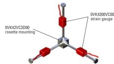
Extensómetros en configuración en 3-D
