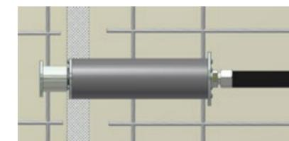
Esquema de instalación de deformímetro embebido
