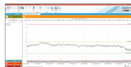
I grafici mostrano lo sghembo dei binari e relativi livelli di allerta/allarme
