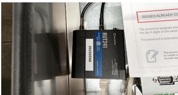
Ultimo passaggio: collegare ENTRAMBE le antenne ai due connettori etichettati come "MOBILE" sul router, come mostrato in figura. I cavi delle antenne devono passare attraverso il pressacavo inferiore dell'armadio. Le antenne devono essere posizionate in modo da garantire un segnale sufficientemente forte per la trasmissione dati.
