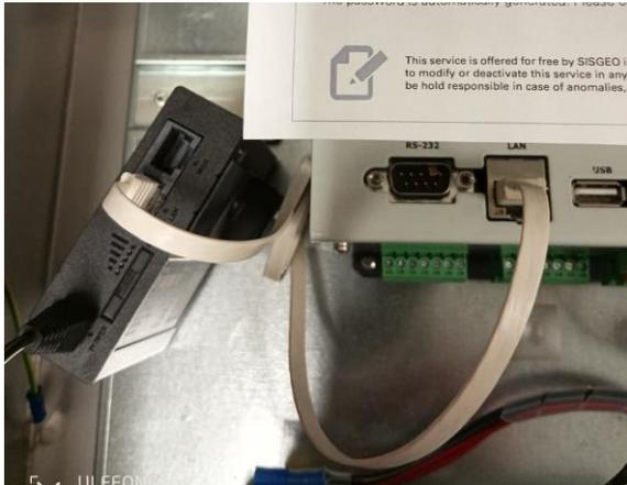
Ora collegare un'estremità del cavo LAN fornito all'interno dell'armadio alla porta "LAN" dell'OMNIALog, e l'altra estremità alla porta "LAN" del router (NON collegare il cavo alla porta "WAN" del router).
