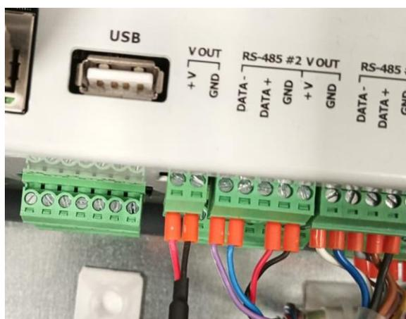
Il cavo di alimentazione fornito deve essere collegato alla morsettiera dell'OMNIALog, nella sezione V OUT, come segue:
