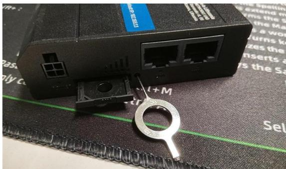
Per inserire la scheda SIM (non fornita da Sisgeo), aprire lo slot della SIM come indicato in figura.
