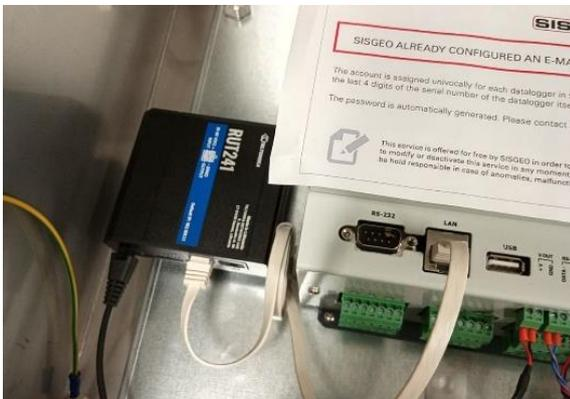
Inserire il router sulla flangia dell'armadio in modo che la parte con i connettori delle antenne sia rivolta verso l'alto. Premere con decisione fino a bloccarlo in sede, finché non si sente un CLICK.
