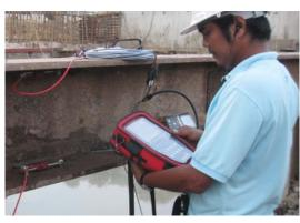
\* los datos se registran sobre una tarjeta SD interna y pueden ser fácilmente descargados sobre un PC a través de un cable USB.
