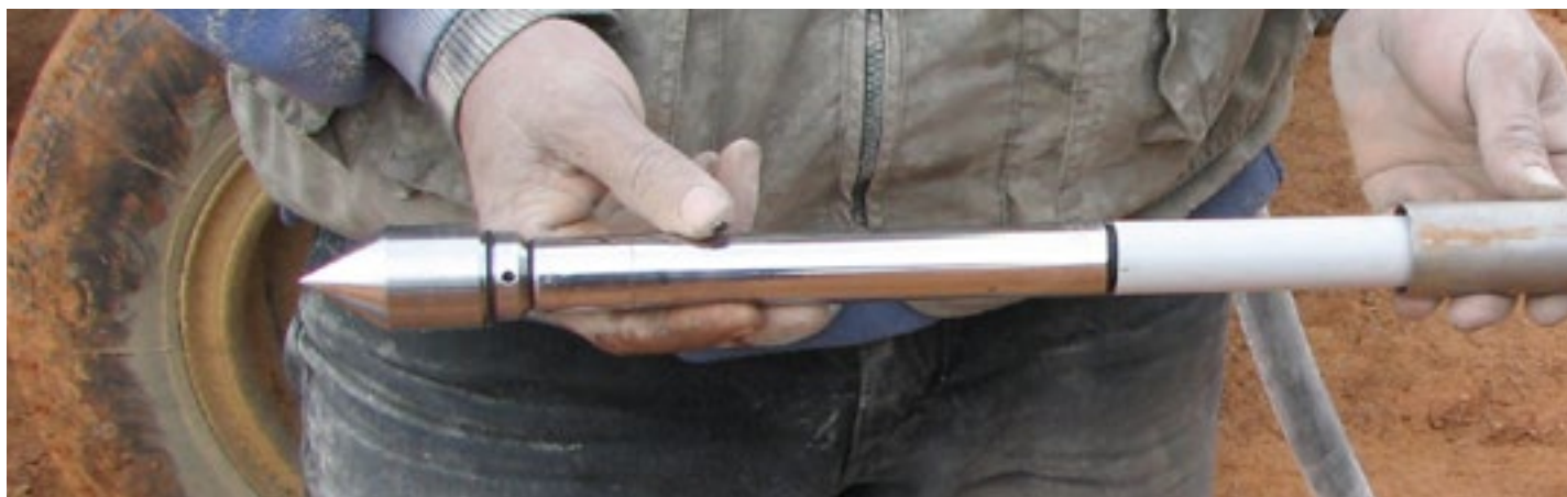
Piezometro a infissione con asta di spinta
