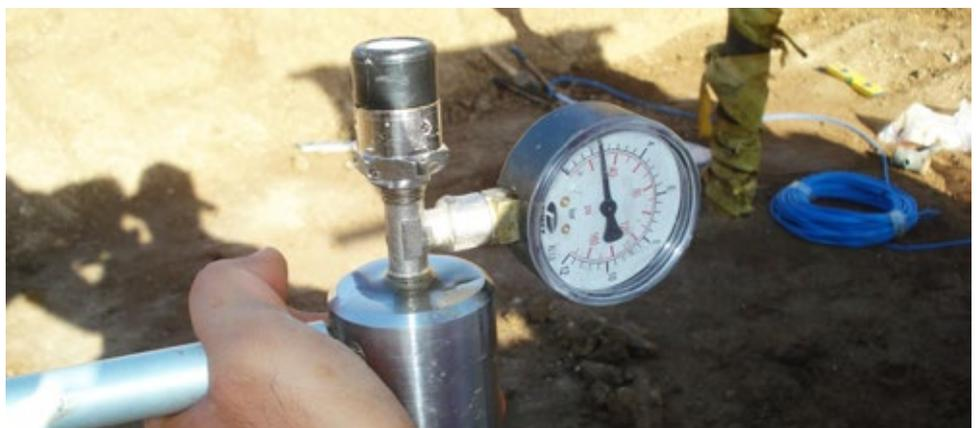
Saturation du filtre HAE avec l'appareil de saturation
