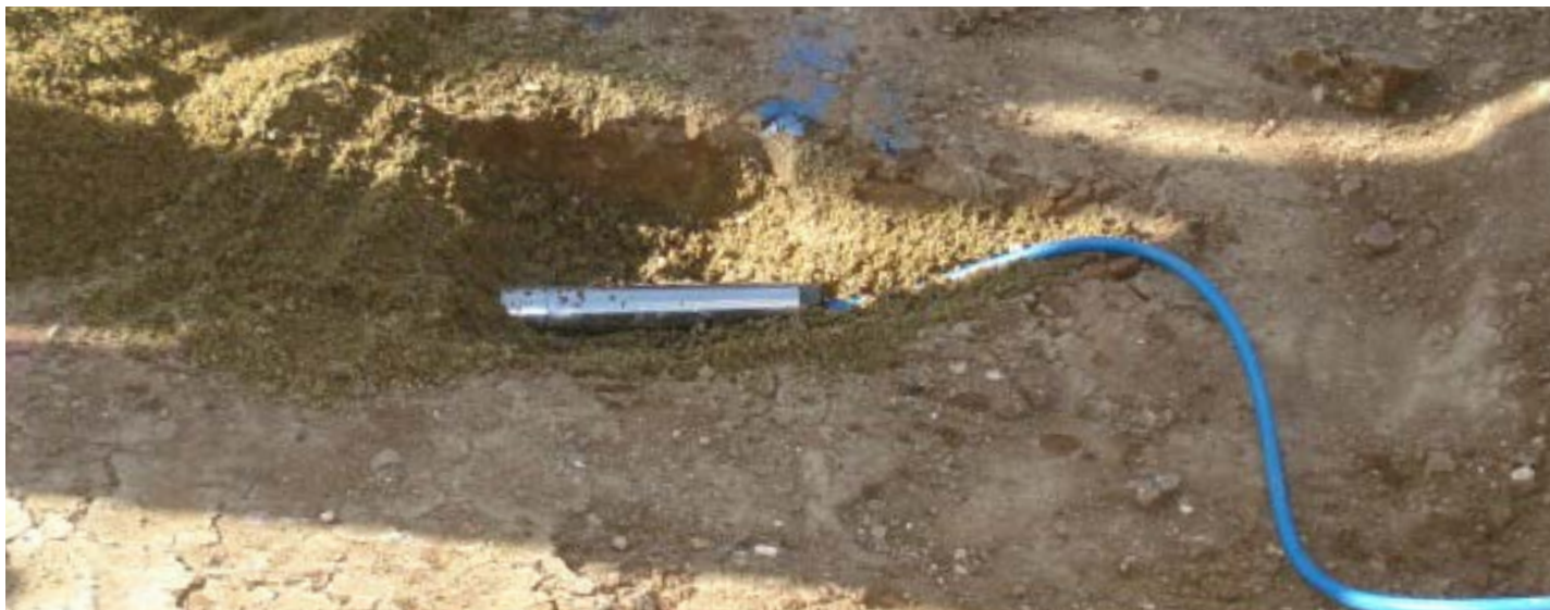
Piezómetro de cuerda vibrante en la cimentación de una presa de materiales sueltos
