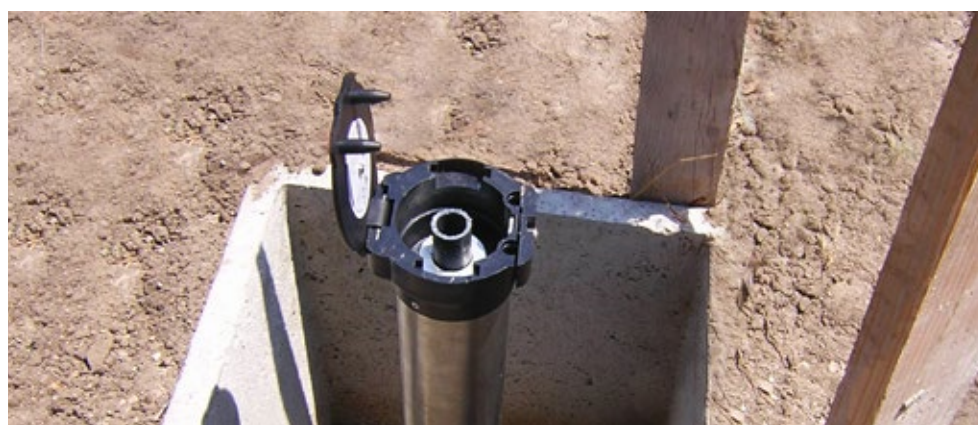
Cabezal de medición Tell - tale sin perno de estudio
