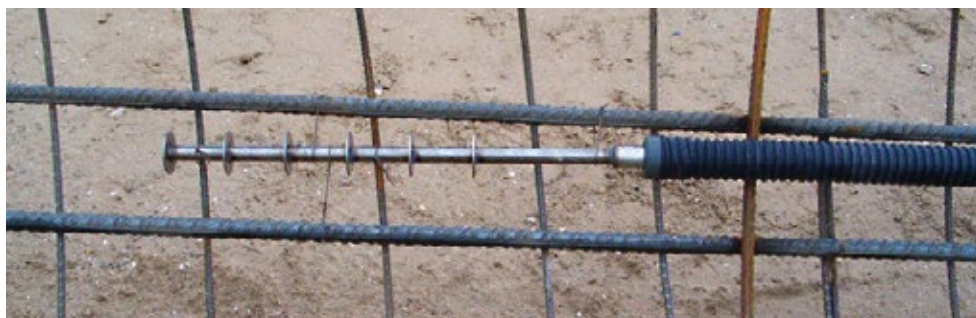
Anclaje de fondo del Tell - tale para referencia de datos
